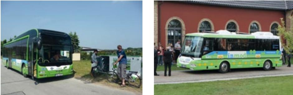
Abbildung 35: Nachhaltiger intermodaler ÖPNV – Dieselhybridbus und Pedelecs mit Ladestation
