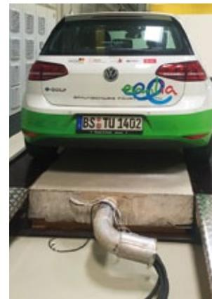
Abbildung 33: Induktive Ladung von Pkw im Labor
